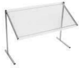
Edelstahl 18/10 geschliffen, Kunststoffabdeckung transparent (PMMA), Neigung Abdeckung einstellbar, Höhe Unterkante vorne mind. 38 cm
